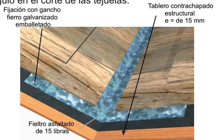
Solución de limahoya, para cubierta de tejuela sobre tablero base placa.
