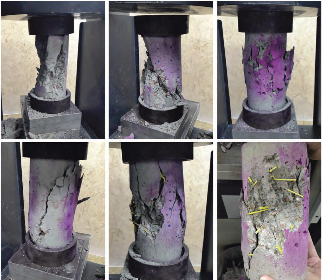
Imagen 23\_Ensayo resistencia a la compresión
