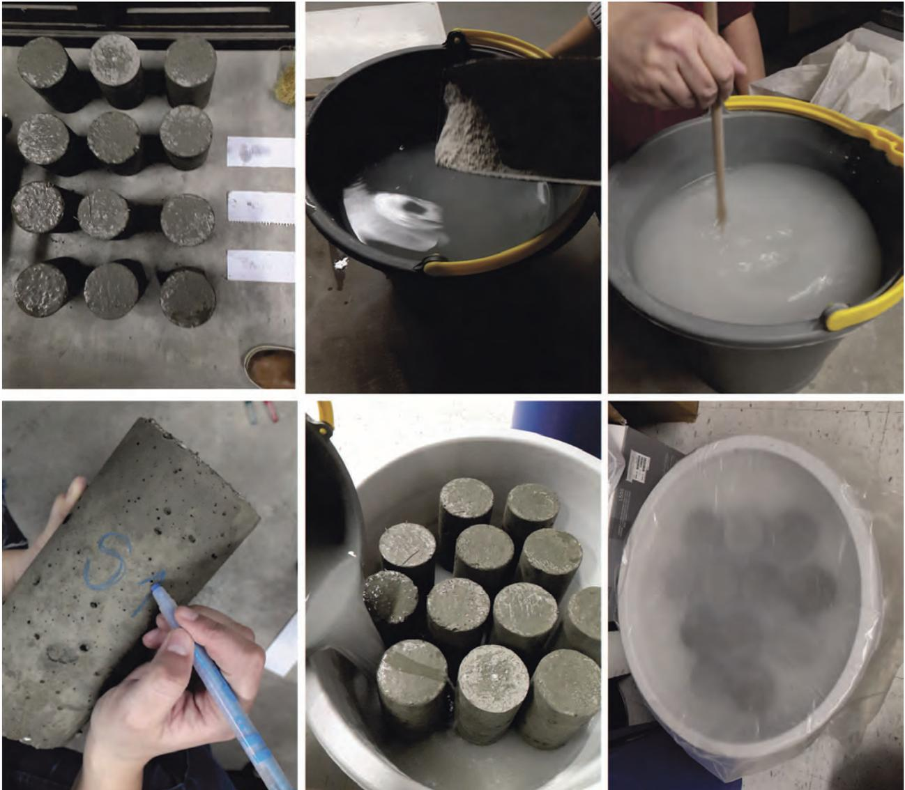
Imagen 18\_Curado de Probetas
