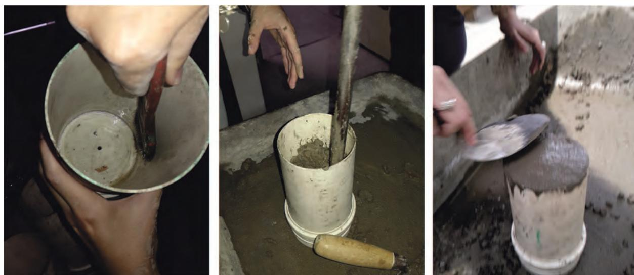
Imagen 17 \_Llenado de probetas
