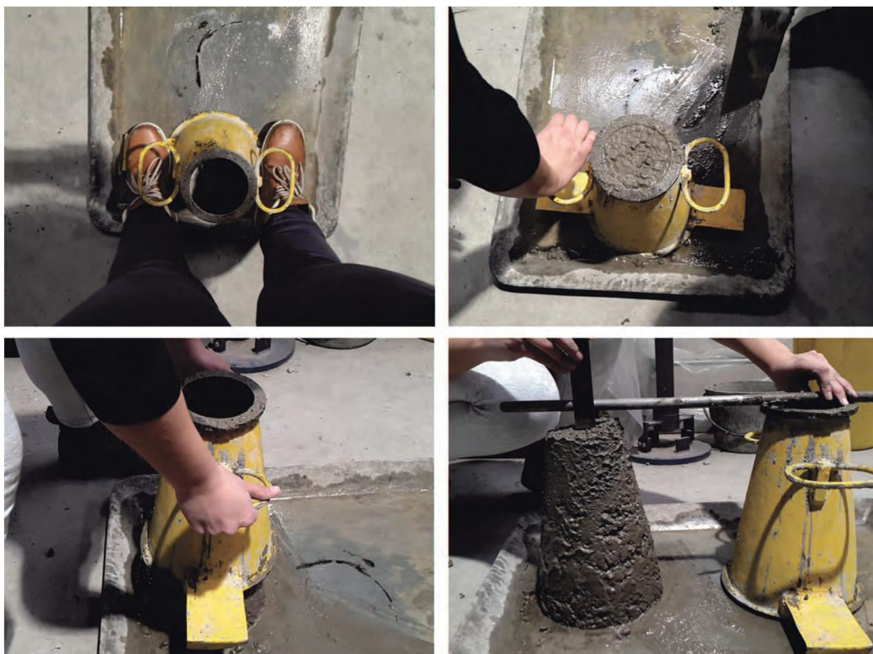
Imagen 16\_ Ensayo Cono de Abrams
