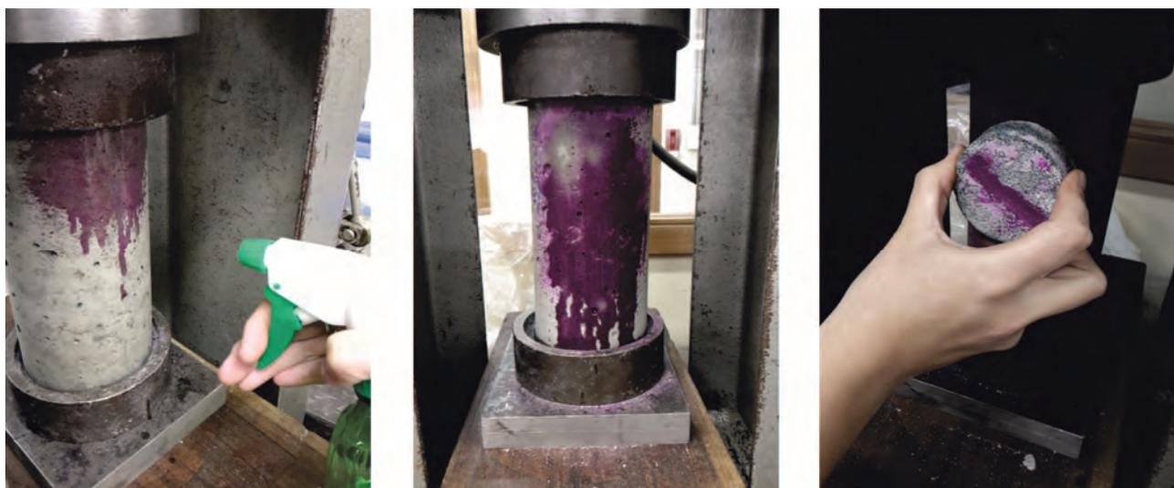
Imagen 19\_ Rociamiento de probetas con Fenolftaleína y raspado con piedra abrasiva
