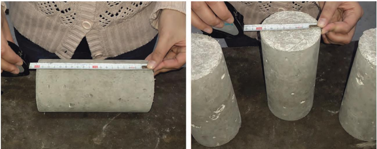
Imagen 24\_Dimensionado de probetas
