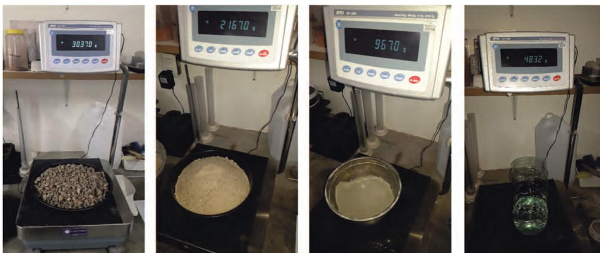
Imagen 5\_Materiales: árido grueso-árido fino-cemento-agua
