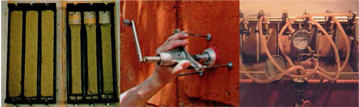
Figura 49\_ Determinación de la contracción de secado.
