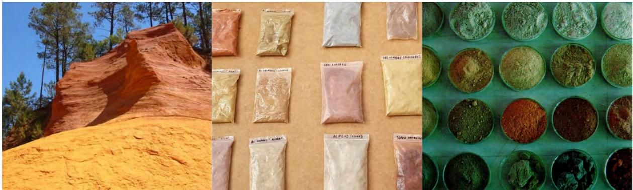
Figuras 27, 28 y 29\_ Diferentes tipos y coloración de la tierra producida por la existencia de óxidos metálicos.
