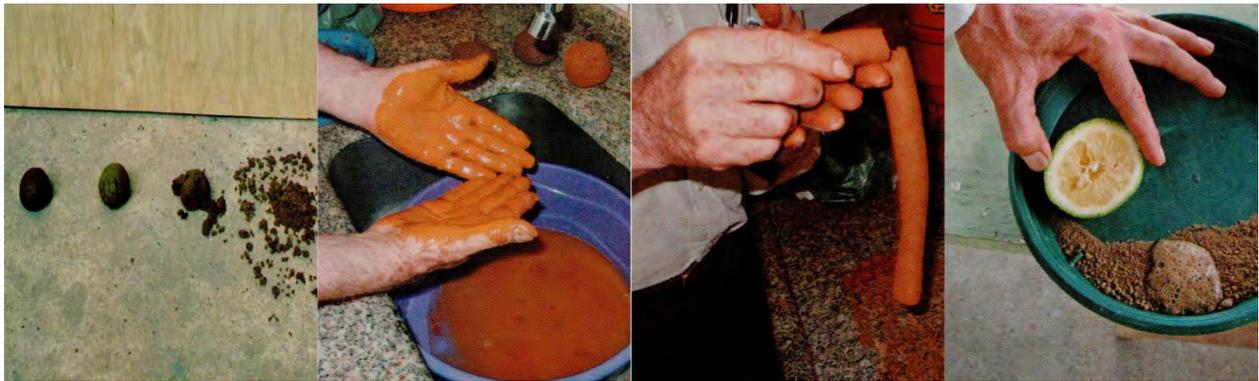
Figuras 52, 53, 54 y 55\_ Ensayos de campo: caída de la bola, frotado y lavado, cohesión, acidez.
