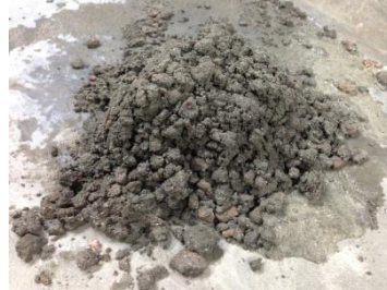
Figura 25: Mezcla de áridos, cemento portland y agua con fibras homogéneamente distribuidas
