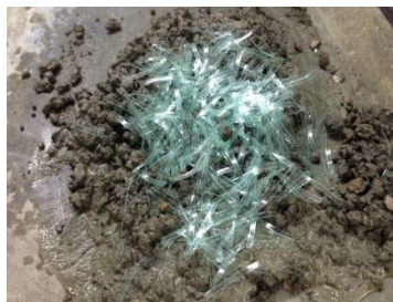
Figura 18: Mezcla de áridos, cemento portland, agua y fibras de PET
