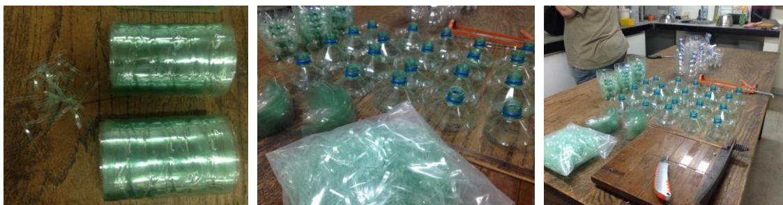
Figura 8: Proceso de producción de las fibras de PET a partir de botellas de agua Salus®
