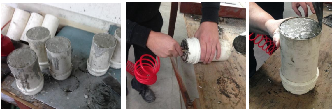
Figura 17: Probetas con tapa de PVC y desmolde de las mismas con aire comprimido
