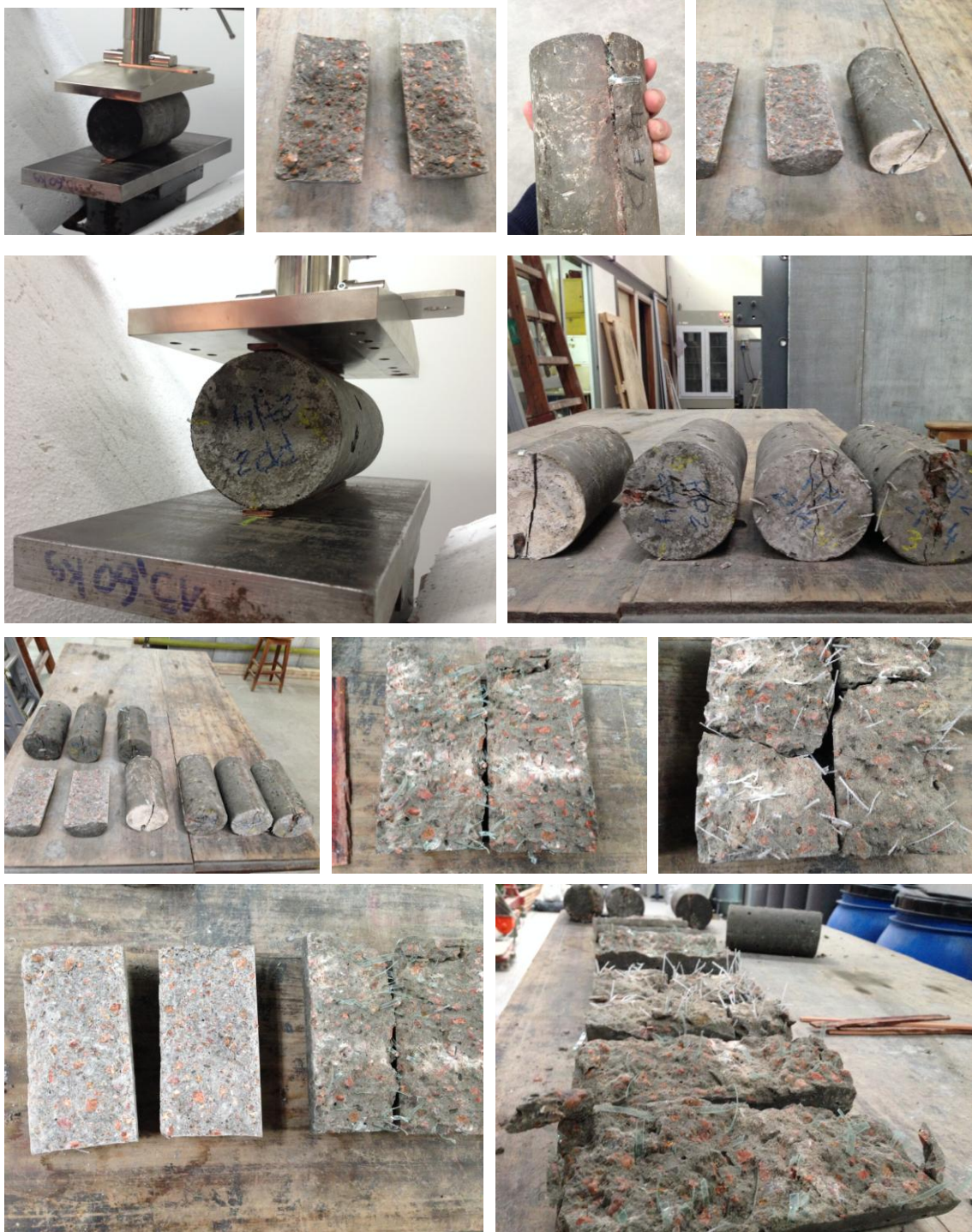
Figura 29: Probetas durante y posterior al ensayo de compresión diametral
