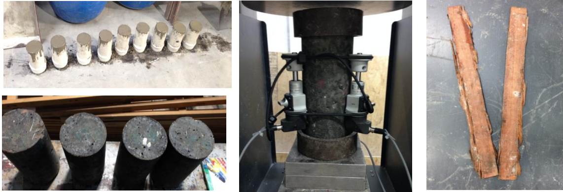
Figura 12: Probetas cilíndricas para los ensayos y fibras prensadas
