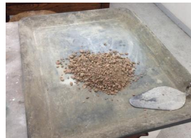
Figura 22: Batea con árido grueso
