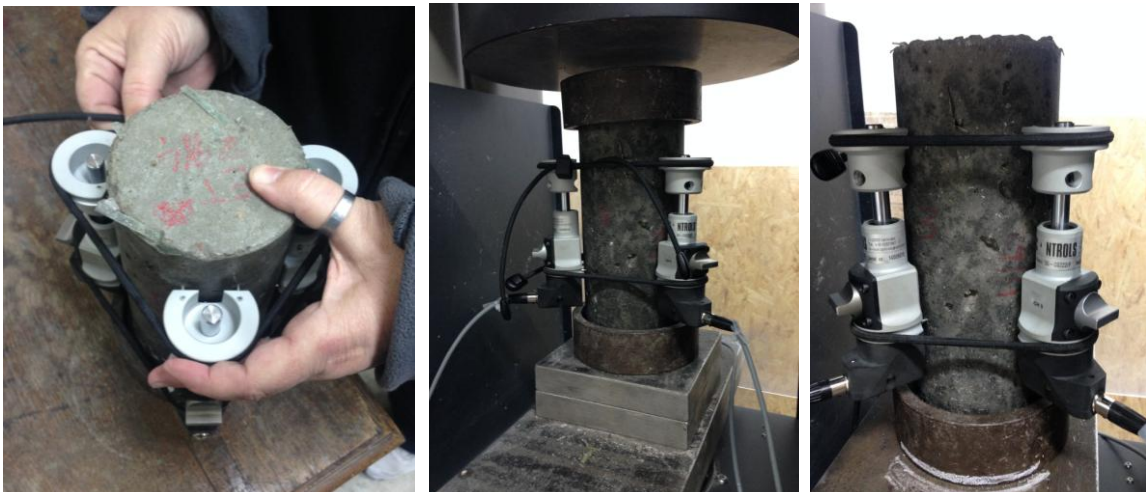
Figura 28: Procedimiento para ensayo de módulo elástico
