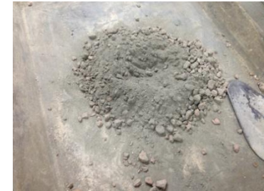
Figura 19: Árido grueso, fino y cemento portland mezclado
