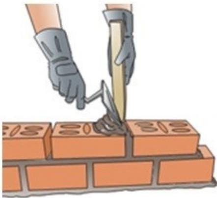
Figura 15 – colocación del mortero vertical
