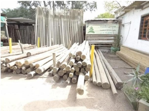
La madera no viene seca del todo, siempre viene con un resto de humedad, la mayoría de las tablas las tenemos parada en unos secadores, como tijera para que agarren aire en el proceso de secado final que es lo más cómodo para secar, lo terminamos el secado acá.
