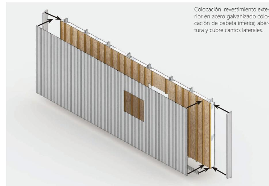
Colocación revestimiento exterior en acero galvanizado colocación de babeta inferior, abertura y cubre cantos laterales.
