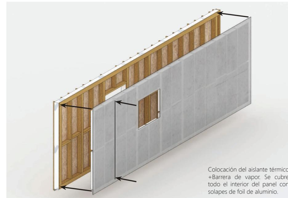
Colocación del aislante térmico +Barrera de vapor. Se cubre todo el interior del panel con solapas de foil de aluminio.
