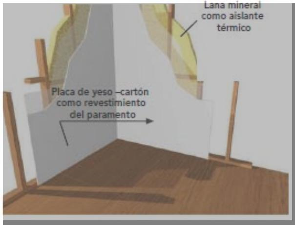
Fig. 11 - Muro interior revestido con placas de yeso cartón.
