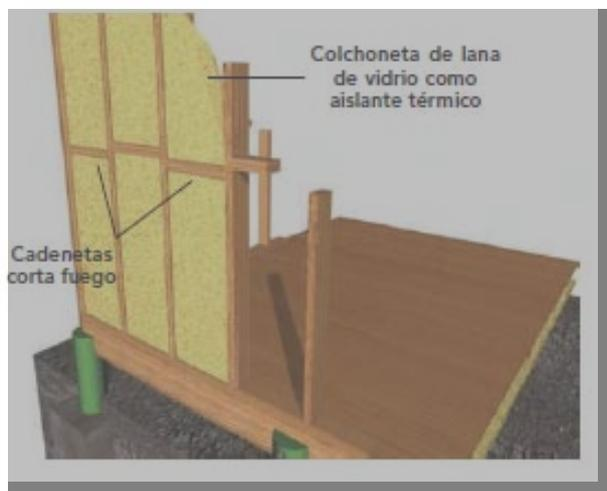
• Planchas o rollos de lana de vidrio: Producto fabricado fundiendo arenas a altas temperaturas con alto contenido de sílice y con adición de otros componentes. Gracias a diferentes procesos de fabricación adicionales, es posible obtener productos en múltiples formatos como rollos, paneles u otros, de variados espesores, densidades y que pueden tener diferentes revestimientos adicionales.
