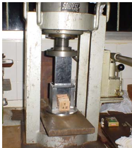
Fig. 6.7 – Dispositivo de cizalle ubicado en la prensa de carga [Foto: M. Calone]
