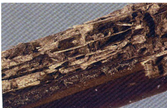
Foto 3.11 – Madera dañada por termita. Se aprecia el aspecto de láminas [Fuente: Guía de Insectos y Acaros de importancia forestal en Uruguay]
