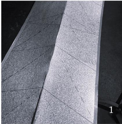
1- Se dibuja el patrón del origami sobre la chapa, verificando la dificultad al momento de proseguir con los segundos pliegues. Se toma la decisión de cortar a la mitad.
