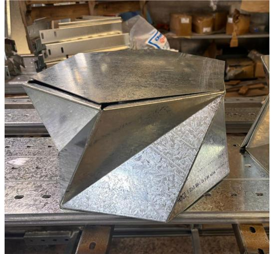
53-54- Pruebas. Pieza E1 en chapa, verificación de los pliegues. Prueba de shito 2.
