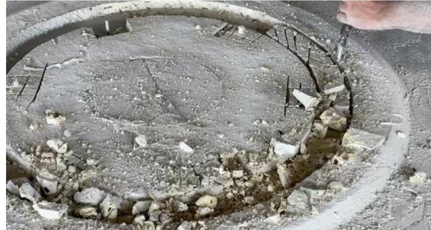
Después de terminada la parte inferior de la tapa se prosiguió a darle vuelta, de manera de trabajar la parte vista. Para ello se armó un andamio con un guinche y poleas, con las cuales se ayuda para manipularla y depositarle sobre pallets. Con el mismo sistema de guinche se bajó la base hasta el piso, para rodarla y trabajarla de manera vertical.
