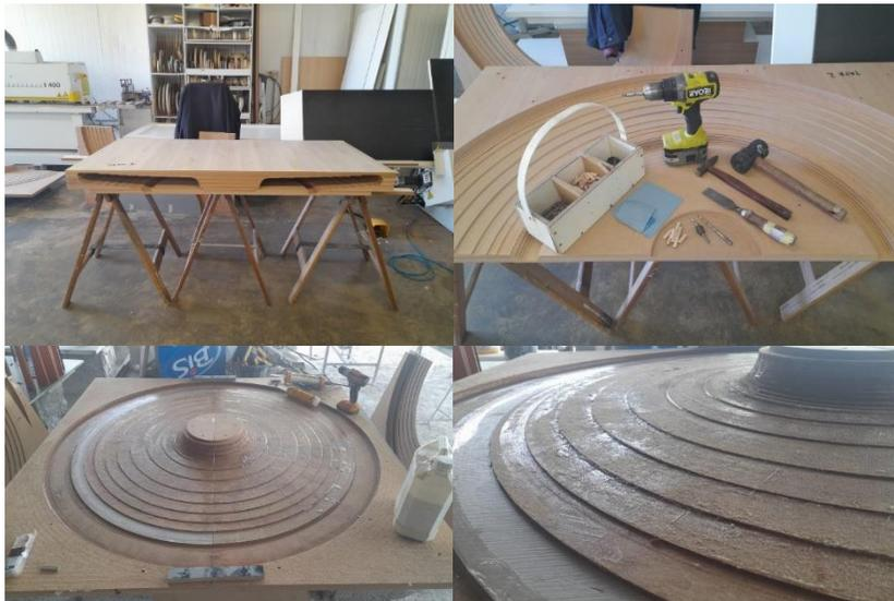
Sobre el molde de la base, el mismo se realizó con la técnica de costillas, la cuál consta de una base y tapa ruteadas a las que se les incrustan costillas en sentido radial. Estas costillas se cortaron con Router CNC con la forma deseada. Luego una vez armada la estructura de costillas se forro con una lámina de PVC 1mm, esta se cortó en gajos y se unió a las costillas utilizando pegamento y
