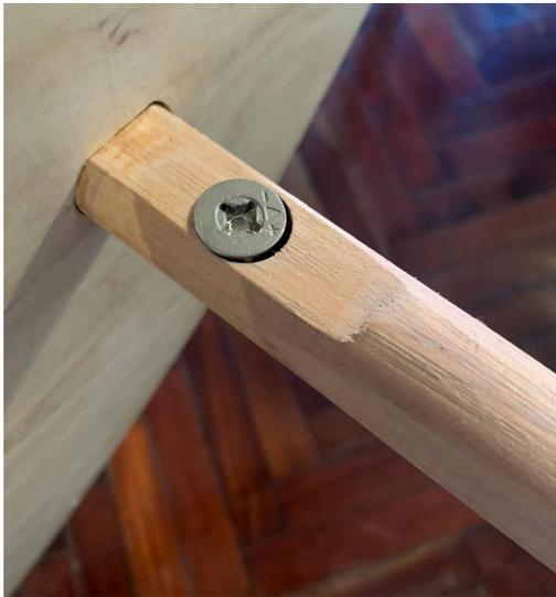
Unidas por barrotes de madera de 24 mm. Fueron cortados a 11 grados según el ángulo de las placas y se aplanó una cara en los apoyos para instalar los minifix. Este sistema minifix los une a las placas, permite que el mueble sea desmontable y deja la cara frontal de la placa sin cabezas de tornillos a la vista.
