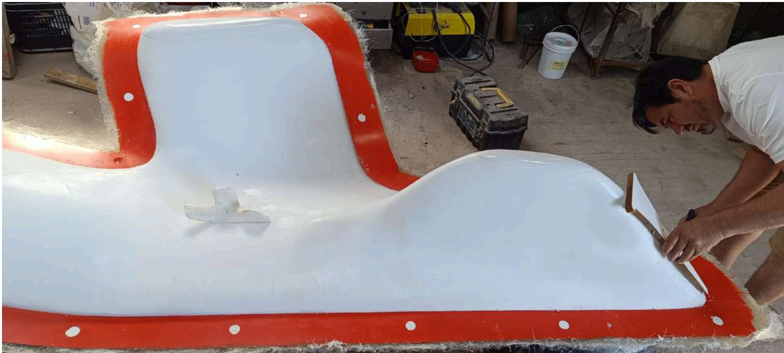
Fabricación de aleta del molde superior o “lomo”
