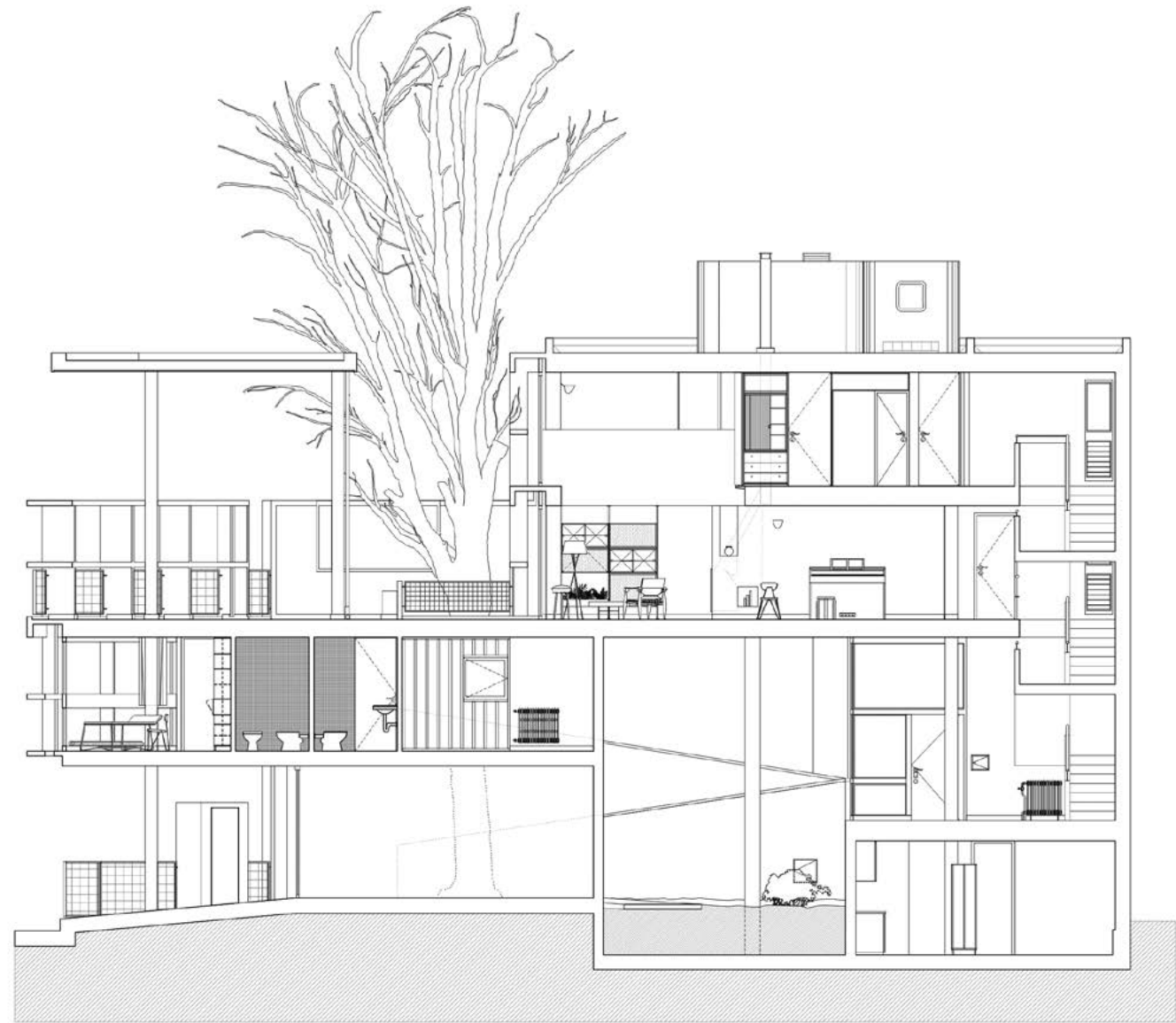
Laminario Casa Curutchet. Corte longitudinal general equipado A-A. Vista hacia la rampa de ingreso. Relevamiento y dibujo: Diego Cedrés.
