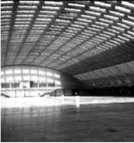
Nervi siempre sostuvo que la elegancia estética de sus edificios residía simplemente en su corrección estructural. Inventó un nuevo tipo de hormigón armado (capas de mallazo de acero sumergidas en la masa de hormigón) que le permitió la construcción de una de sus obras maestras, el gran salón de la Exposición, donde la cubierta de celosía ondulada salva una distancia de 76 m y consigue un inmenso espacio interior tan dramático como los de las catedrales góticas.
