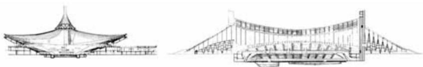
La cubierta ténsil consiste en una membrana sostenida por dos pilares de hormigón armado formando una red de cables de acero sobre la que, mediante soldadura, se fijaron placas de acero esmaltadas. La forma curva de la cubierta garantiza su resistencia a la presión del viento, que a veces es huracanado en esta zona.
