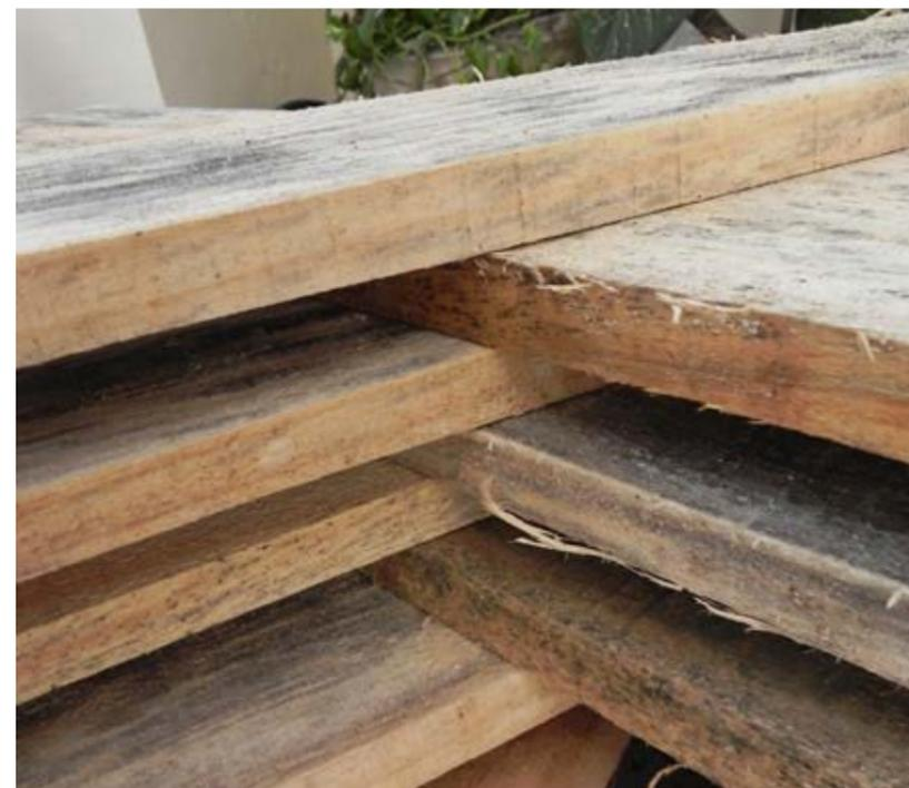
Secado de tablas, detalle de apoyo en un extremo del apilado en triángulo.
