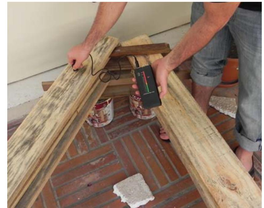
Medición del contenido de humedad. Tablas separadas del piso.
