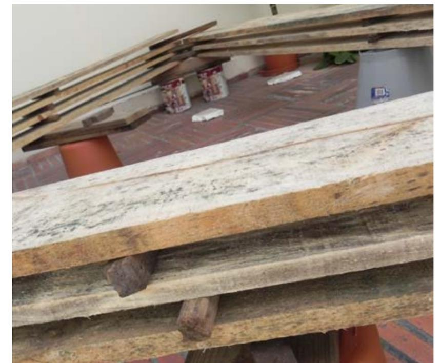
Secado de tablas, detalle de apoyo intermedio.
