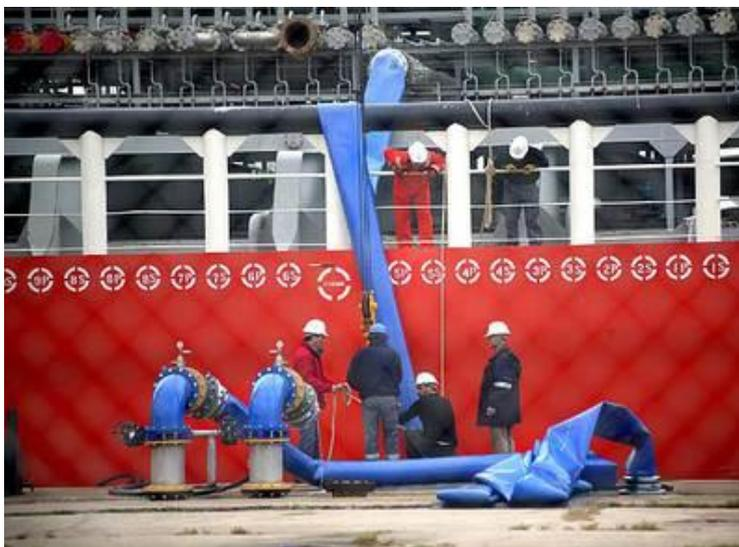
**Fig. 4.** Operarios llevando a cabo el protocolo de llenado de grandes depósitos de agua potable dentro de grandes embarcaciones.
