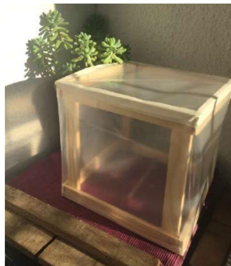
El modelo de control se colocó en el exterior de la vivienda, orientación oeste. Se observó que en el horario comprendido entre las 08:00 y las 17:00 la temperatura aumentó entre 3 y 5°, variando la misma según la temperatura ambiente.
