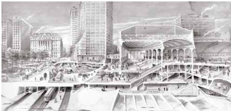
Fig. 4.13 Propuesta para una ampliación de la terminal en Park Row dibujada por Harry M. Pettit (1912 circa). El corte muestra los vínculos entre las plataformas de los trenes con los trolleys y el subterráneo. El Municipal Building aparece cortado en sección y está incorporado al sistema de intercambios a través de Chambers Station.
