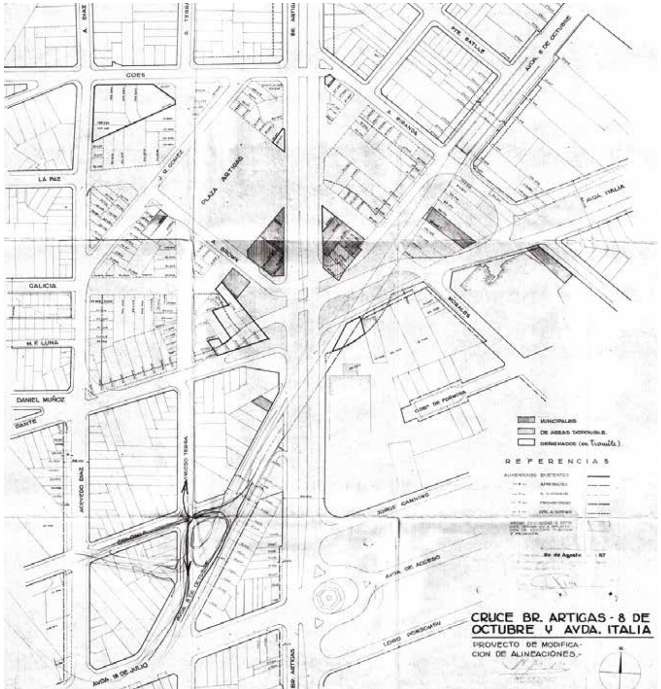
Fig. 12 Proyecto de modificación de alineaciones y trazado del túnel realizado bajo la dirección de el Arq. Américo M. Ricaldoni indicando los padrones expropiados y la nueva forma del espacio urbano resultante, 1957.
