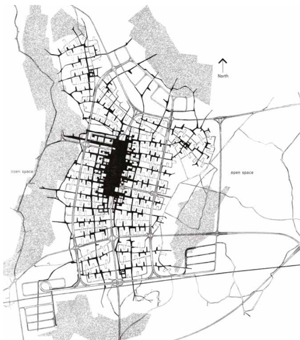
Fig. 4.19 LCC, planta del sistema de plataformas peatonales elevadas de la ciudad de Hook, 1961.
