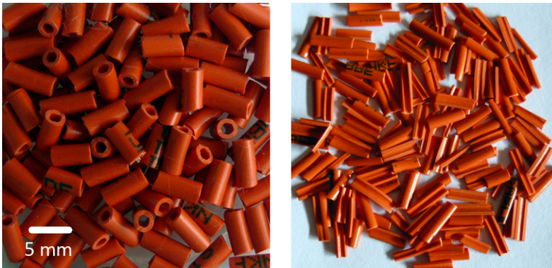
Figura 3.11 - Fibras obtenidas de cilindros huecos Sección entera (izquierda) – Cuarto de sección (derecha)
