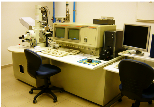
Figura 3.19 - Microscopía Electrónica de Barrido (SEM) Equipo SEM (izquierda) – Muestras metalizadas en oro (derecha)
