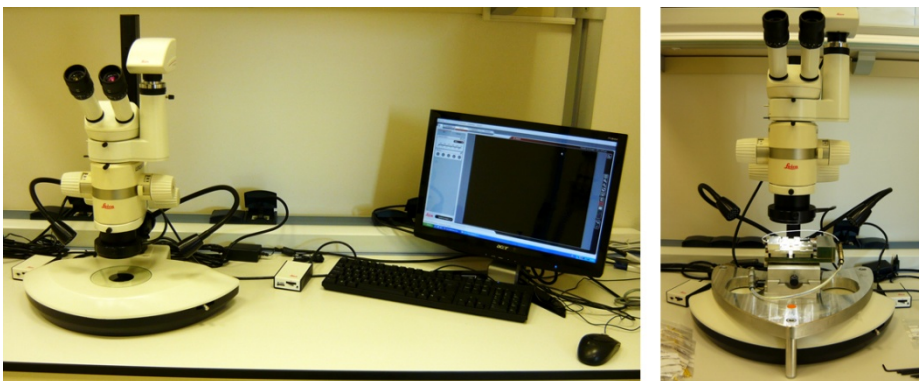
Figura 3.18 - Microscopio Óptico Lupa (izquierda) – Lupa con Microtest (derecha)
