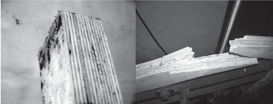
Probeta tipo con adhesivo de resorcinol
