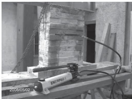
adquirido con fondos del proyecto, inserto en un muro de prueba, para verificación del procedimiento de ensayo y prestaciones del mismo.
