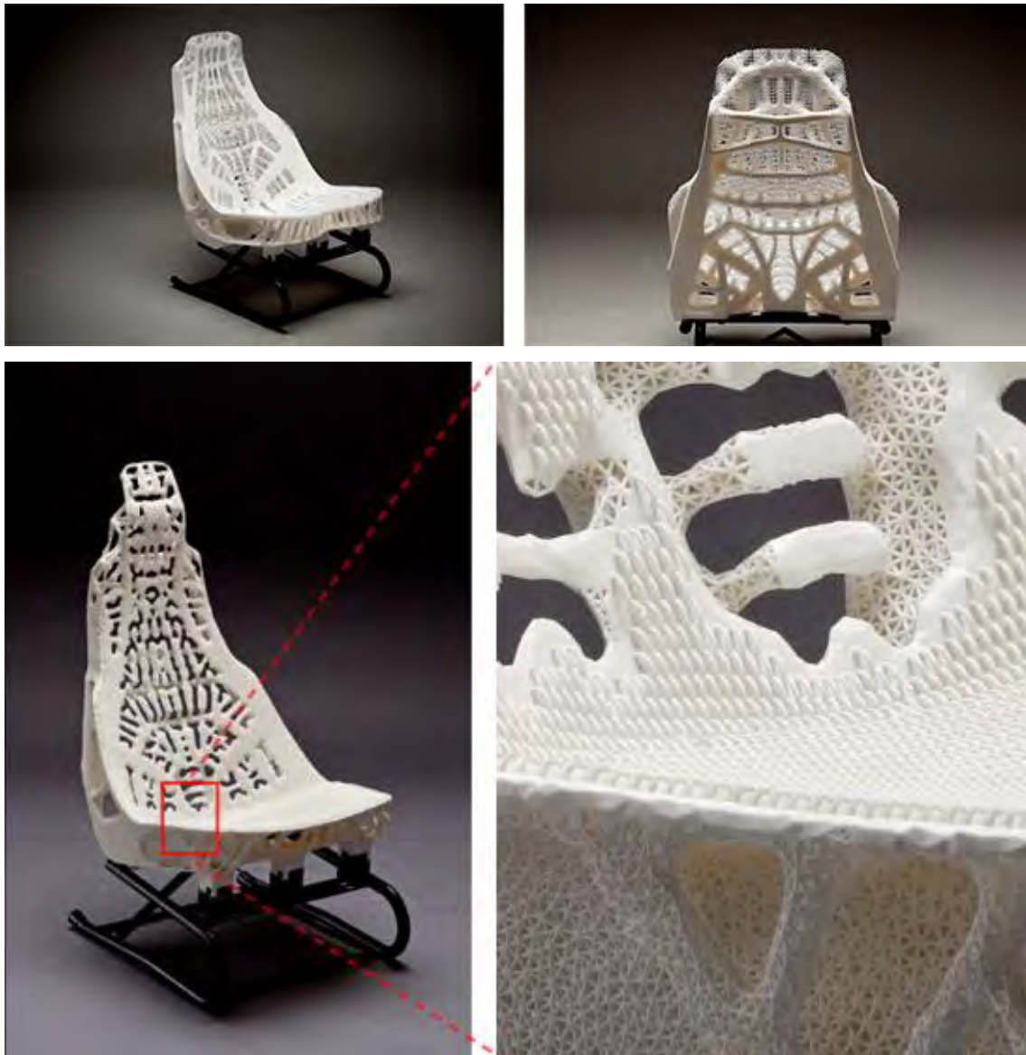
14.- Prototipado de asiento para Toyota, similar a la suela del zapato deportivo Adidas Futurecraft se imprime mediante técnicas tipo SLS (Sinterizado Selectivo por Láser) y para la conformación del archivo de impresión se deben manejar datos CAD y datos que provienen por ej de la digitalización de zonas de mayor y menor calor de acuerdo al contacto del cuerpo con el asiento.
