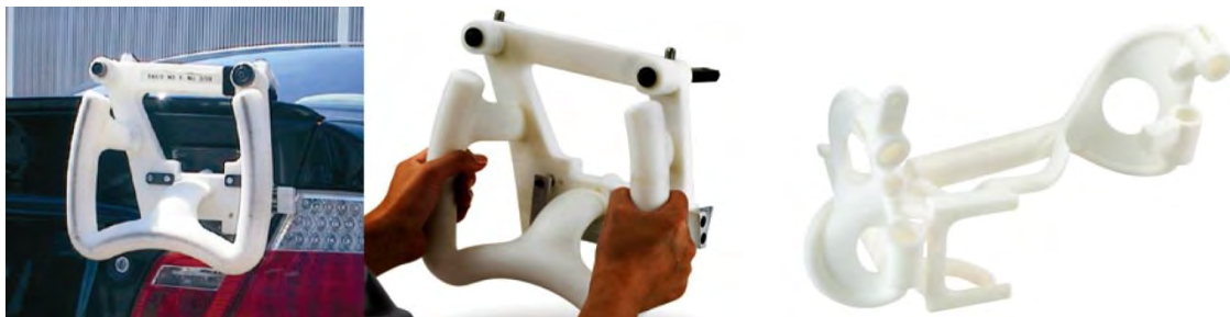
15.- Herramientas y plantillas de colocación realizadas en BMW mediante la técnica deposición fundida (ver FUSED DEPOSITION MODEL o FDM) de esta manera son livianas y adaptables incluso para la mano de cada operario.
