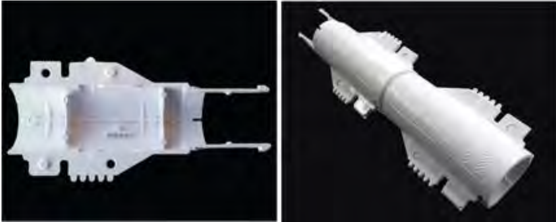
16.- Prototipo de molde para inyección hecho mediante tecnología Poly Jet (ver Photopolymer Jetting) para inyección de plástico y pieza terminada
