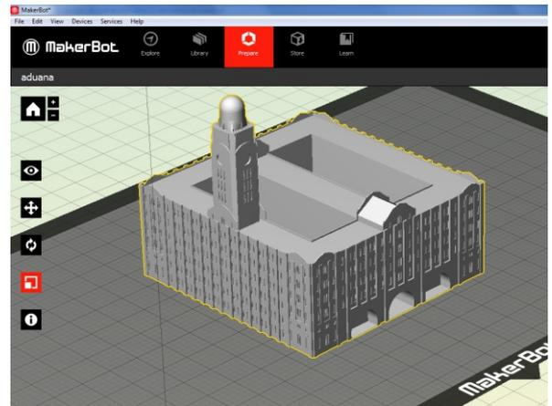
En el software de MakerBot se configuran los soportes, espesor de capa, etc. Y nos da una aproximación del peso de la pieza y el tiempo de impresión.
