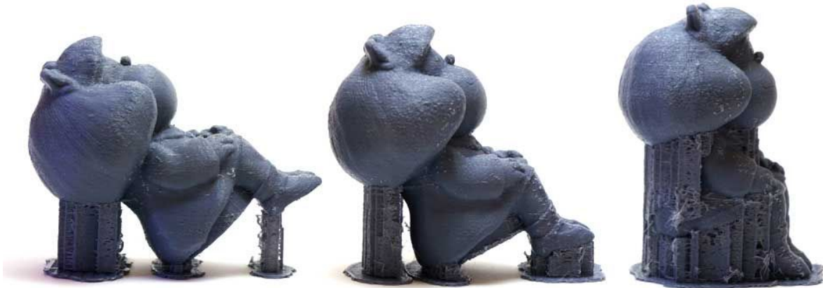
Fig. X - Modelo impreso en 3 ángulos de inclinación distintos. De izquierda a derecha 60°, 30°, 0°.
