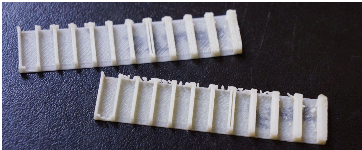
Uno de los modelos de piezas utilizados en los ensayos. Se pueden observar diferencias en cómo los distintos espesores son resueltos.
