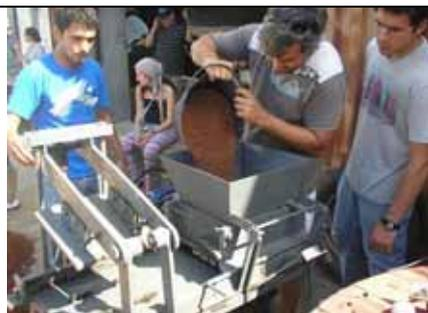
Taller de 30 horas en Salto – maquina hidráulica BTC diseñada y fabricada en Salto
