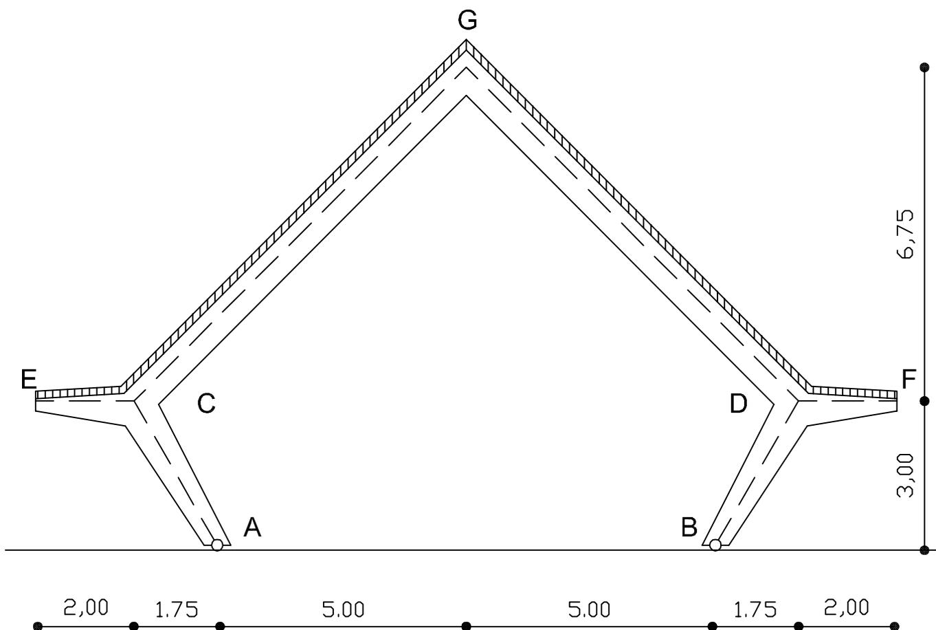
Estudiar las solicitaciones de la estructura que se indica por el Método de Cross. Los tramos AC y BD tienen, en su apoyo articulado, una sección de 20 x 47 cm, y en el otro extremo, de 20 x 80 cm. Los tramos CG y GD son de sección constante, de 20 x 80 cm. Las ménsulas EC y DF tienen una sección de 20 x 40 cm en sus extremos libres y de 20 x 60 cm en los empotramientos. Sobre los tramos EC, CG, GD y DF una losa maciza de 15 cm de espesor descarga 2000 daN/m.t.
