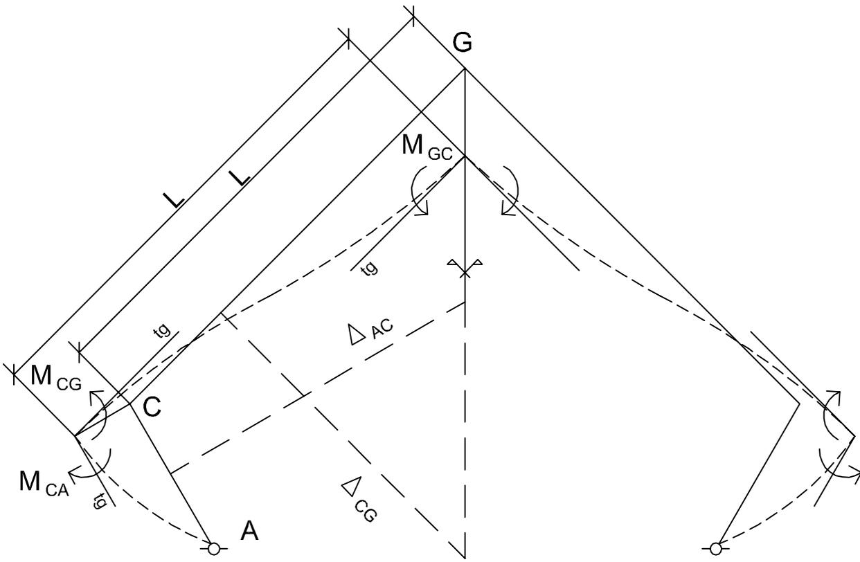
Para medir los desplazamientos de los nudos de cada barra, trazamos perpendiculares a los ejes de cada tramo. Se forma un triángulo que nos permite obtener los valores de los desplazamientos proporcionales a los reales.
