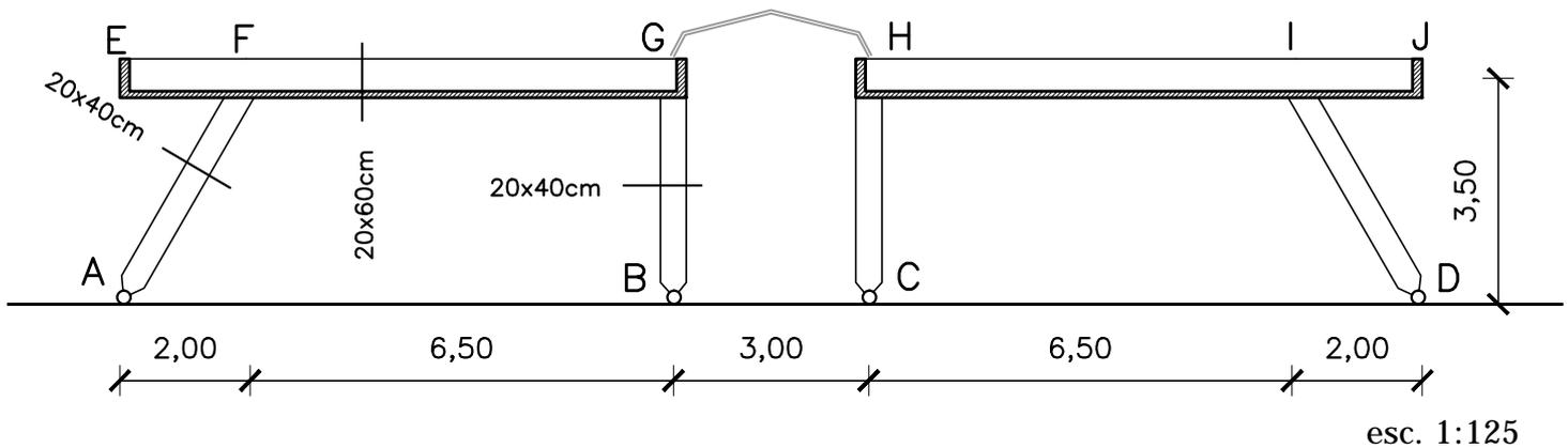
En el gráfico se representa un corte de la estructura correspondiente a un local comercial, consistente en dos pórticos de hormigón armado simétricos, separados por un espacio circulatorio cubierto por un lucernario liviano.
