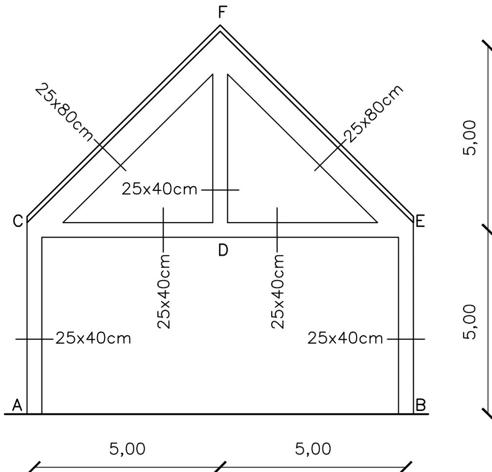
Se presenta la estructura a realizarse en hormigón armado:
