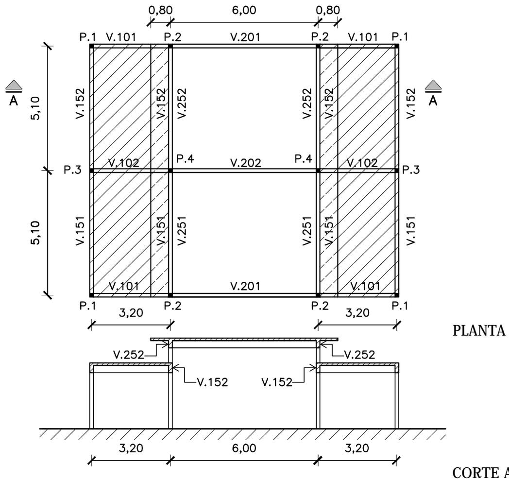
A) Completar el diseño de la estructura representada en el gráfico, a construirse en hormigón armado, proponiendo formas viables de poco hormigón.
