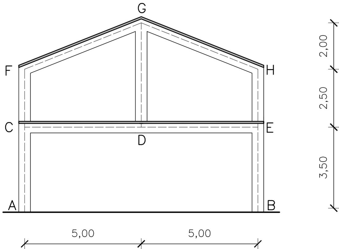
Se presenta el corte vertical de una estructura a construirse en hormigón armado.
