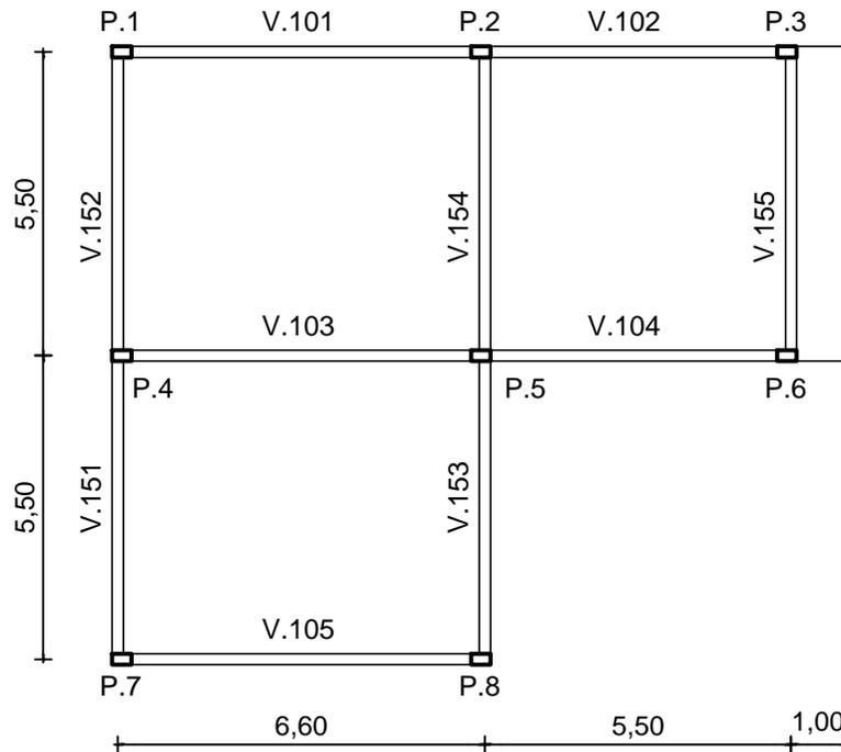
Verificar la viabilidad de la estructura de hormigón armado, cuya planta se indica. Carga total a considerar en las losas:  $p=800 \text{ daN/m}^2$ .
