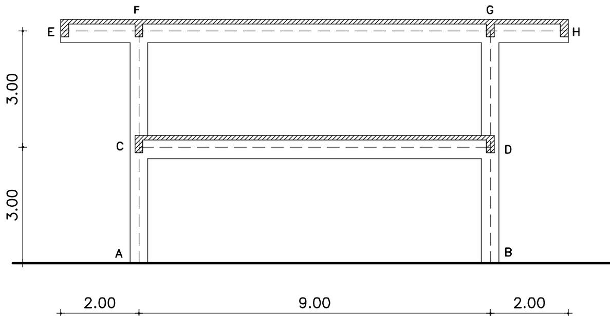
Estudiar el pórtico intermedio de hormigón armado que se indica en el gráfico por el Método de Cross, trazando diagramas de solicitaciones en todos los tramos, indicando reacciones en los apoyos y verificando las secciones más comprometidas. Proponer ajustes en caso de ser necesario.
