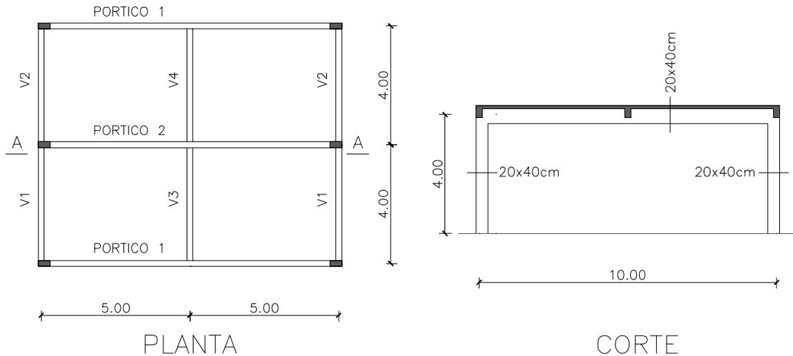
Se presenta la planta y el corte de una estructura de hormigón armado, conformada por losas que se apoyan en vigas y pórticos.
