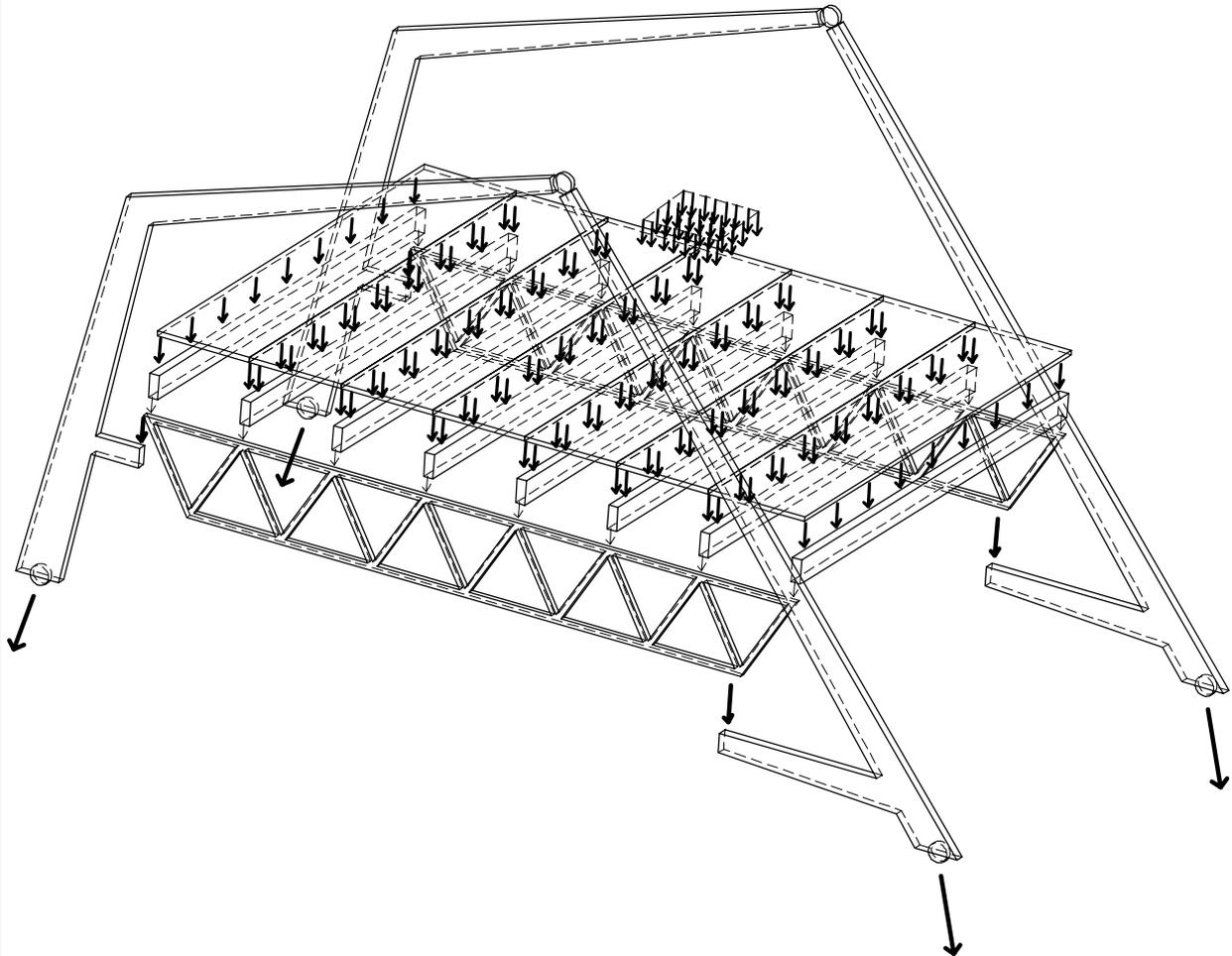
El entablado soporta su peso propio y la sobrecarga por metro cuadrado, y transmite a las correas una descarga por metro lineal.
