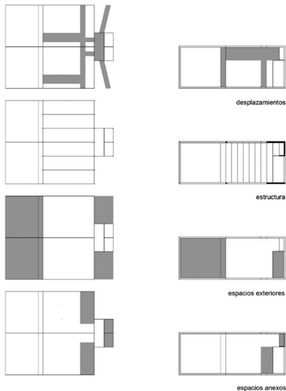
**Figura 10.** Diagramas de aulas tipo A (izq.) y tipo B (der). Sobre un esquema del aula se expresa con manchas gris claro los desplazamientos, los espacios exteriores y los espacios anexos. Para el diagrama de estructura se dibujaron las principales líneas estructurales; con relleno negro, los muros y pilares portantes. Dibujos del autor.
