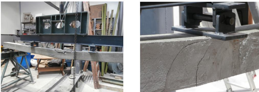
Figura 4 – Rotura producida en ensayo de vigas realizadas con MHAD :
